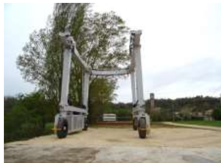
Transbordeur qui va permettre de passer le barrage de Fumel.
